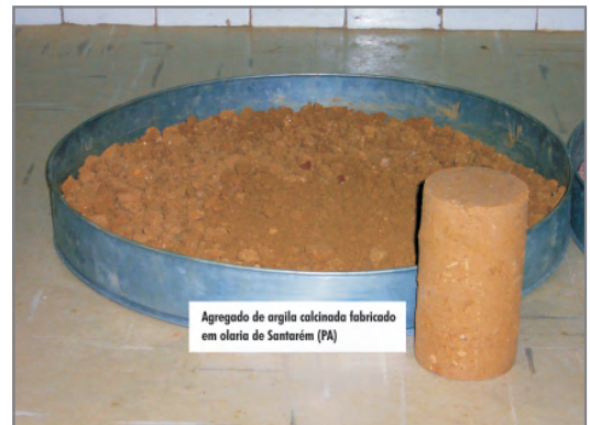
Figura 17 – Resultados de ISC e M_{R\text{médio}} das misturas solo-agregado. À direita, foto da mistura e corpo de prova do M_R .
