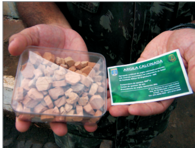
Figura 6 – Amostra de argila calcinada produzida em laboratório no IME, disseminada aos produtores cerâmicos em Santarém (PA).
