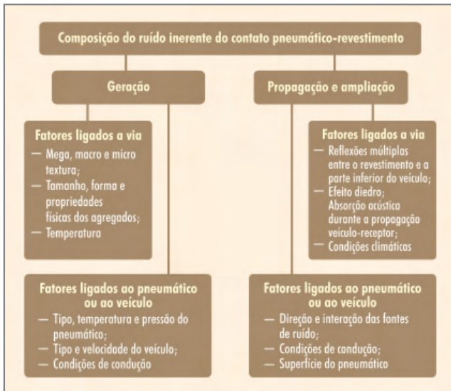
Figura 7 – Fluxograma representativo da composição do ruído de contato pneumático-revestimento (OCDE, 1995).
