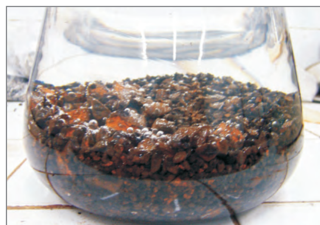
Figura 20 – Execução do ensaio de Rice [3].
