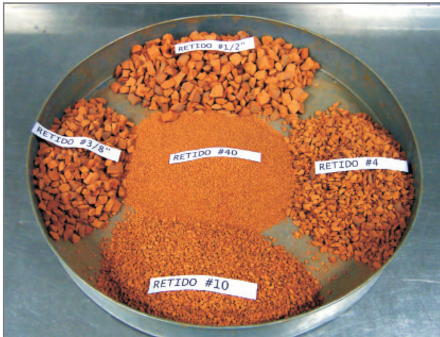
Figura 7 – Agregado de argila calcinada produzido em olaria de Santarém (PA).
