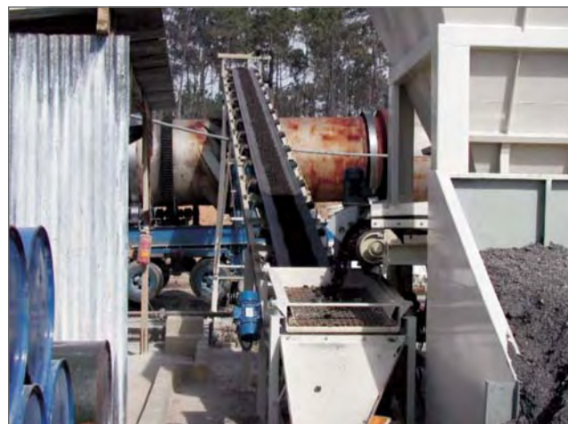
Figura 1 – Introdução no anel central das misturas betuminosas fresadas
