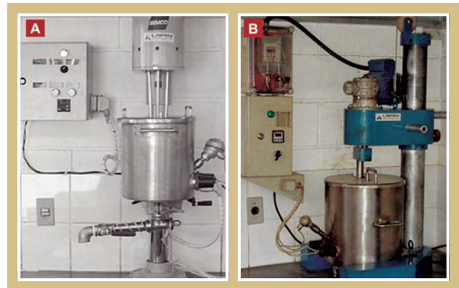
Figura 1 : Equipamentos utilizados para preparo das amostras: a) Misturador asfalto-borracha; b) Misturador de concreto asfáltico
