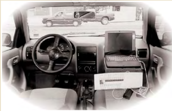
Figura 1 – Interior de um veículo equipado com instrumentos adequados para o LVC.
