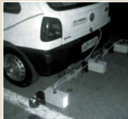
Figura 3 – Ilustrando o equipamento a laser e a disposição dos sensores na traseira do veículo na posição considerada normal.
