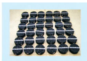
Figura 5 – Corpos-de-prova confeccionados no SGC e usados na presente pesquisa.
