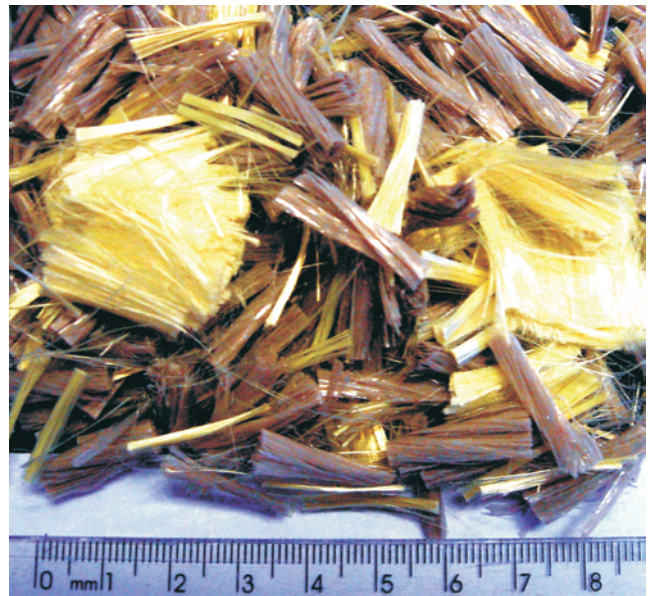
Figura 1 – Detalhe das fibras usadas para adição nas misturas asfálticas: aramida (amarela) e polipropileno (cinza).
