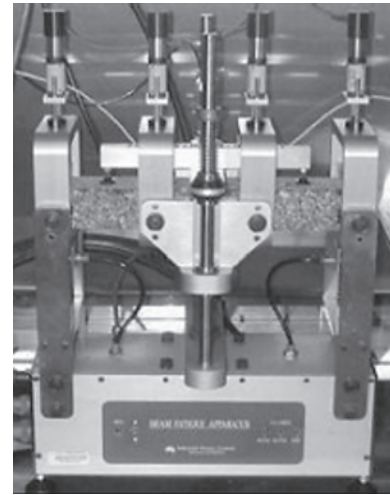
Figura 11 – Equipamento utilizado nos ensaios de fadiga à flexão.
