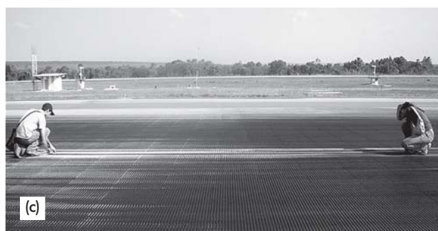
Figura 8 – Trincas longitudinais: (a) de maior extensão; (b) detalhe; (c) processo de medição (SILVA, 2008)
