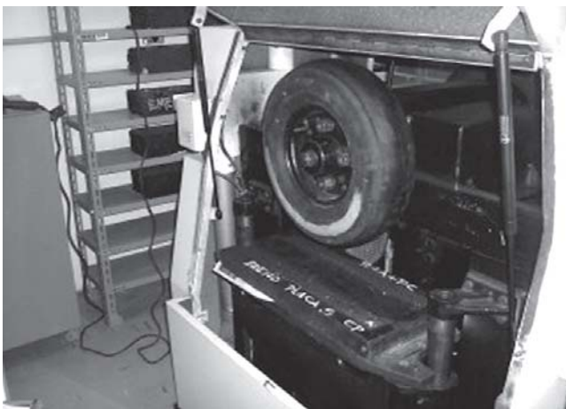
Figura 6 – Câmara termostática da máquina de deformação permanente.
