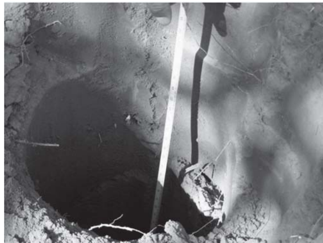
Figura 4 – Trincheira para coleta de material do subleito. (Foto: Wallen Medrado).
