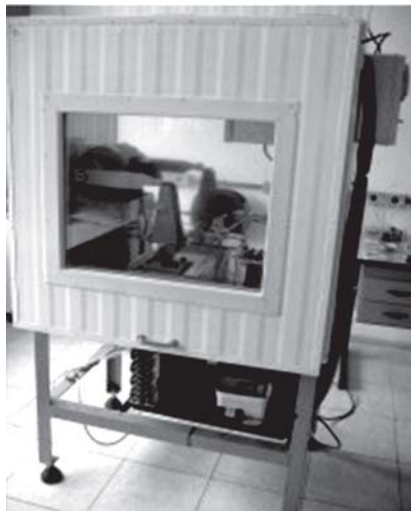
Figura 11 – Câmara térmica da máquina de módulo complexo e fadiga (primeiro e atualmente único protótipo brasileiro – UFSC).
