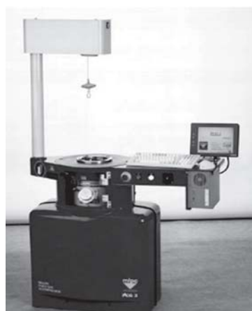
Figura 3 – Prensa de Compactação Giratória 3 (PCG-3) (LCPC, 2010).
