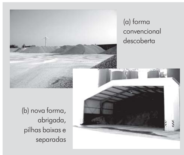
Figura 5 – Exemplos de estoques de agregados. (Fonte: Juan Pablo – Rettenmaier)
