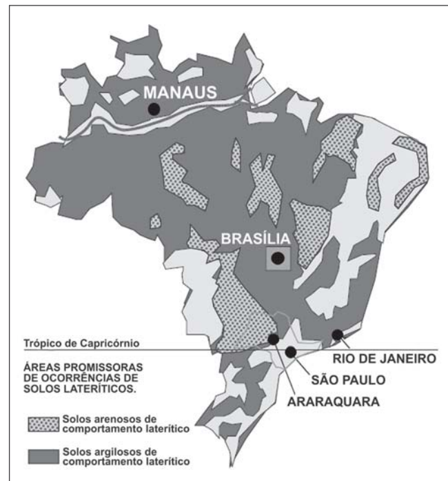
Figura A.4 – Ocorrências de Solos Finos Arenosos e Argilosos, de comportamento laterítico, no Brasil.
