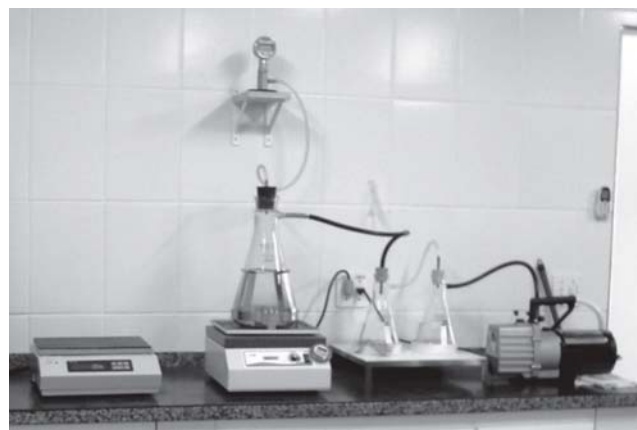
Figura 26 – Equipamento para execução do ensaio Rice de determinação da densidade máxima da mistura no estado solto, (Foto do autor)
