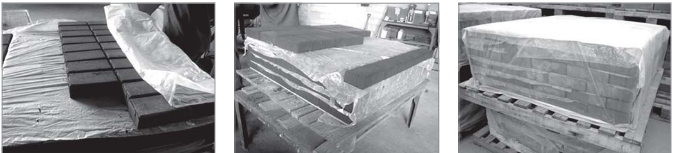
Figura 3 – Esquema do processo de cura das peças de concreto.
