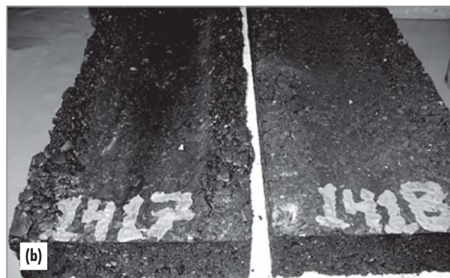
Figura 5 – Placa: (a) antes e (b) depois do ensaio no simulador de tráfego
