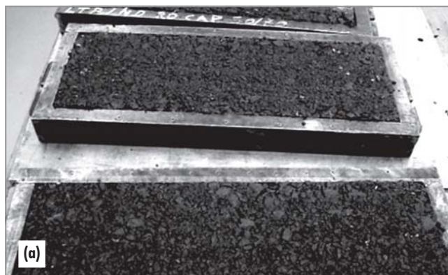
Figura 5 – Placa: (a) antes e (b) depois do ensaio no simulador de tráfego
