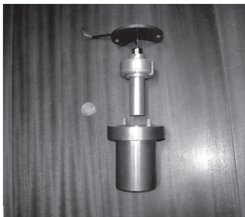
Figura 6 - Captor de deslocamento total utilizado na medição dos dados de deflexão.
