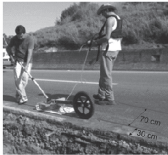
Figura 02. Aquisição dos dados de GPR na Via DUTRA, Pista Sul, km 239+760
