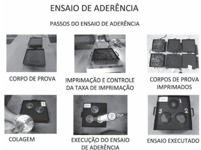
Figura 3: Passos do procedimento do ensaio de aderência deste estudo
