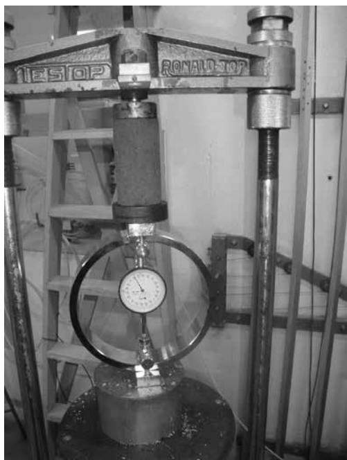
Figura 6 – Aparato (prensa mais anel dinâmométrico) durante o rompimento dos corpos de prova
