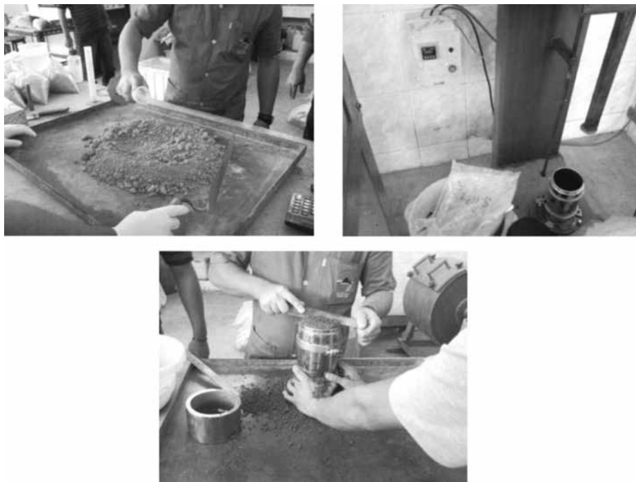
Figura 3 – Sequência da preparação por compactação de um corpo de prova para o ensaio triaxial de carga repetida (MR) deste trabalho, no Laboratório da COPPE/UFRJ
