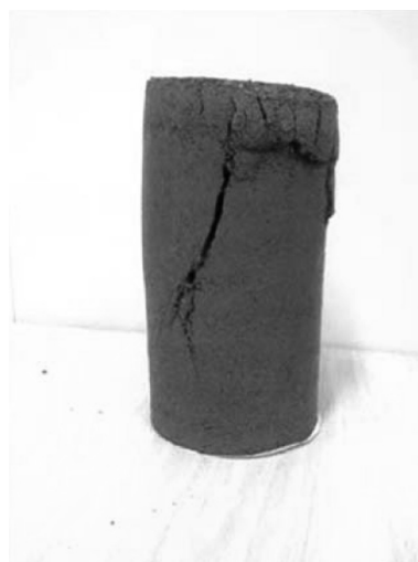
Figura 9 – Corpo de prova rompido após repetição do ensaio 7 (foto dos autores)
