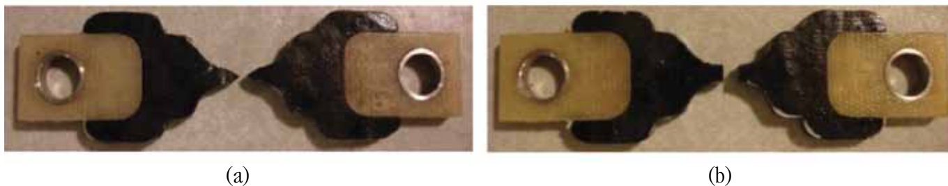
Figura 4 - Exemplo de fratura do corpo de prova no ensaio de tração direta "dog bone": (a) fratura apropriada; (b) fratura prematura
