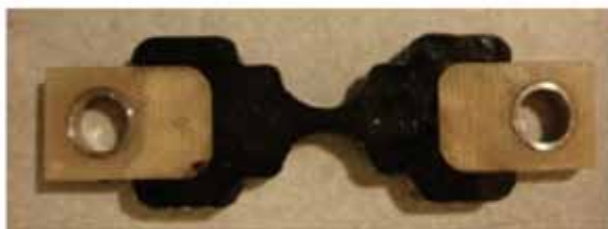
FIGURA 2 - Configuração da geometria final do corpo de prova do ensaio tração direta “dog bone”.
