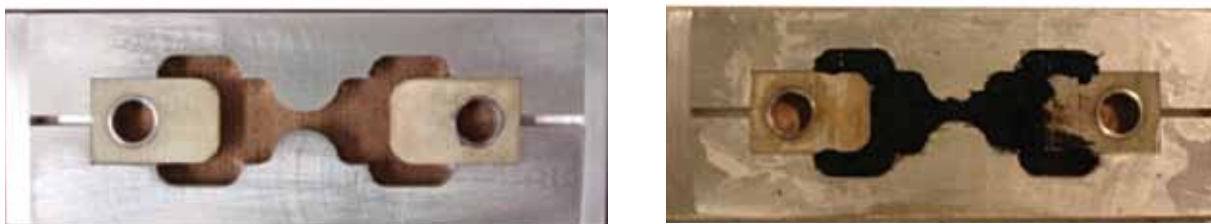
FIGURA 1 - (a) Molde para o corpo de prova do ensaio de tração direta “dog bone”, e (b) Configuração final do corpo de prova preparado com o molde
