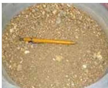
Figura 1 - Detalhe da amostra do Solo utilizado neste estudo após secagem e destorroamento.
