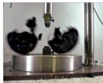
b 3 : amostra se decompõe - final do ensaio
