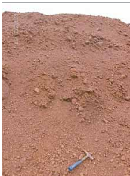
Figura 10: Aspecto de uma jazida de laterita de São Gabriel da Cachoeira/AM. Rodovia BR-307/AM.
