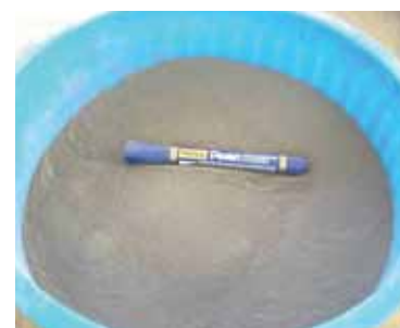
Figura 3 - Aspecto da Cinza Volante utilizada no presente estudo.
