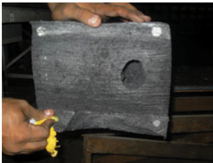
Figura 03 - Dormente polimérico Dormente estruturado com vergalhão de aço e vergalhão de teflon *No detalhe, falha com vazio indesejável.
