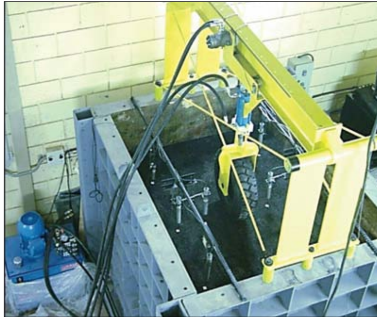
Figura 3 - Equipamento simulador de cargas de tráfego do Laboratório de Geossintéticos (EESC/USP).
