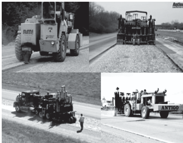
Figura 8 – Exemplos de máquinas utilizadas na fragmentação: a) Fragmentadora ressonante ( resonant breaker ); b) Fragmentadora de múltiplas cabeças autopropelida (SHINNERS, 2009); c) Fragmentadora de múltiplas cabeças acoplada; d) protótipo inicial da Fragmentadora de múltiplas cabeças (THOMPSON, 2006).
