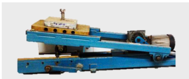
Figura 6 - Equipamento do ensaio de excesso de asfalto por adesão de areia (LWT)
