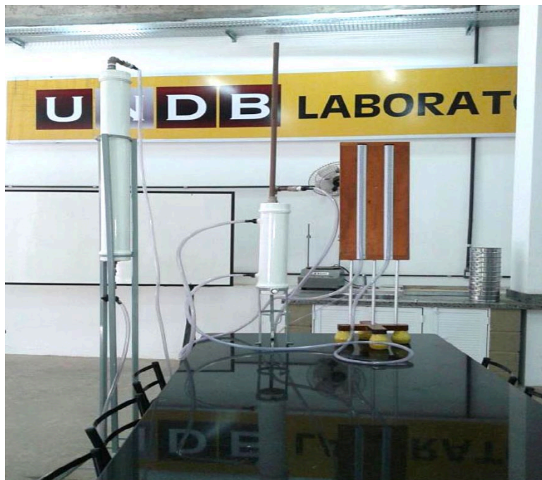
Figura 6 - Ensaio com permeâmetro alternativo laboratório UNDB.
