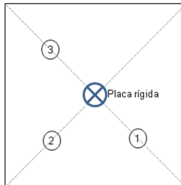
Figura 13 – Esquema em planta, da superfície do pavimento, no tanque dos pontos para realização de ensaios com o LWD
