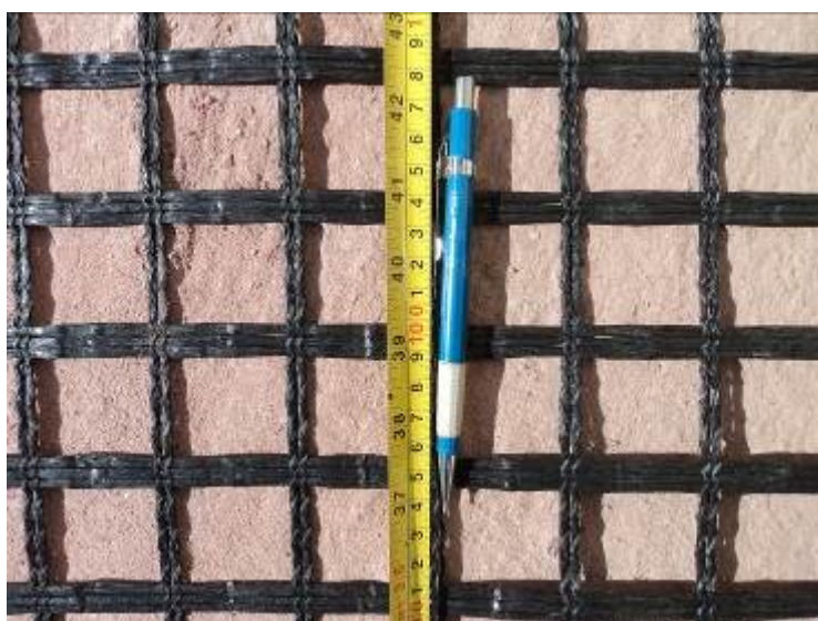
Figura 6 – Geogrelha Fornit J600 (30/30) utilizada nesta pesquisa
