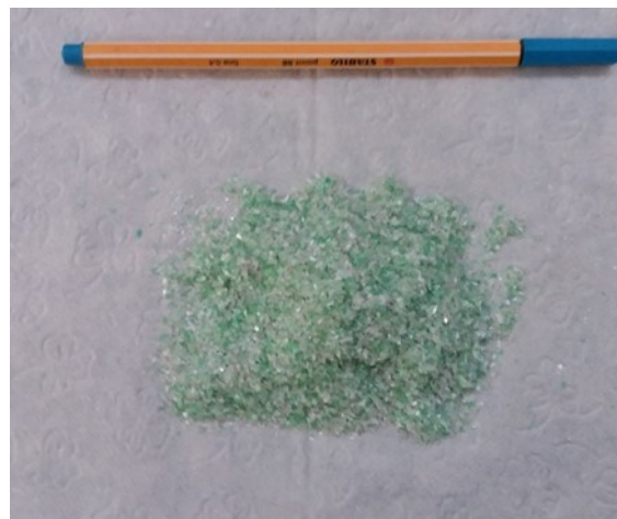
Figura 1 – Flakes de PET de 2mm
