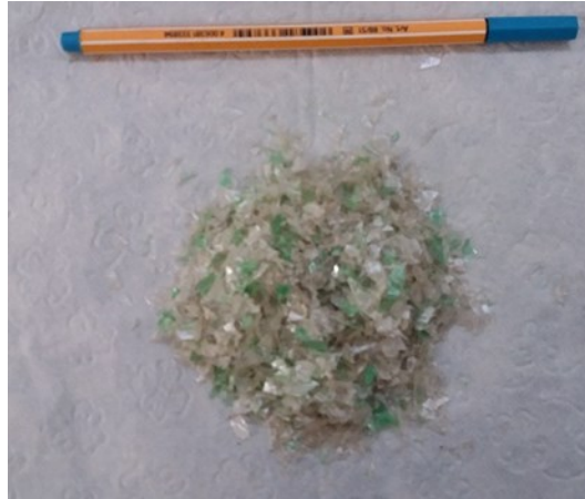
Figura 2 – Flakes de PET de 10mm
