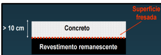
Figura 3 – Fresagem no Whitetopping
