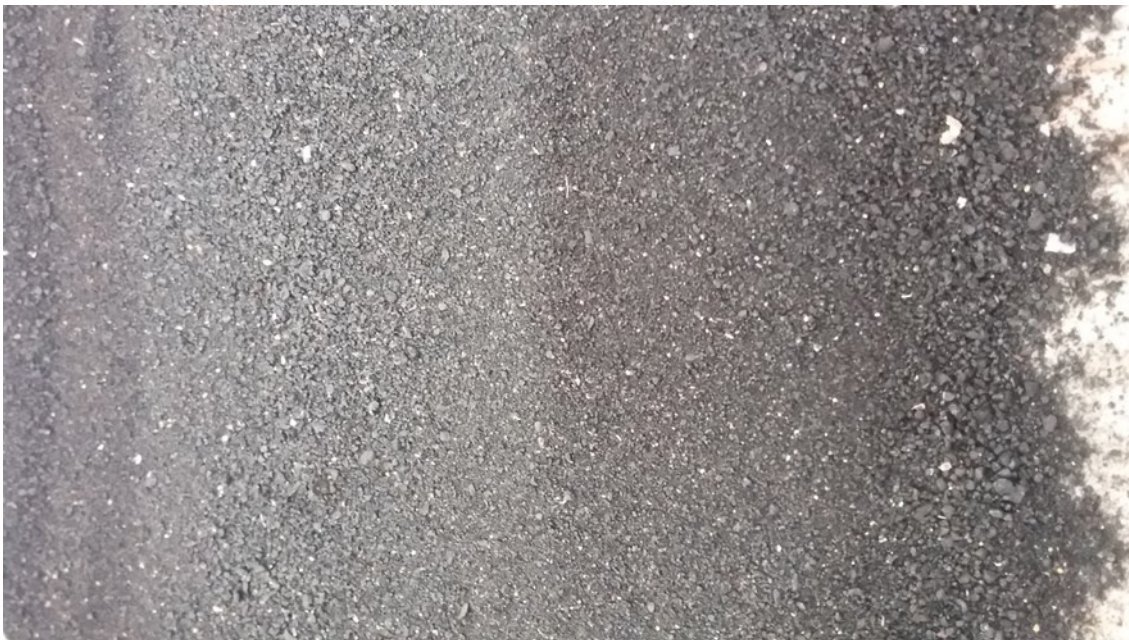
Figura 1: Aparência típica da escória de cobre jateada utilizada nesta pesquisa.
