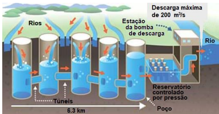
Figura 3 – Esquema do grande sistema de drenagem G-Cans3.
