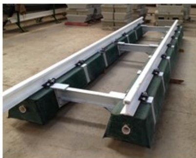
Fig. 12 – Detalhe da tubulação seca embutida para cabeamento de sinalização e de telecomunicações (4.7).
