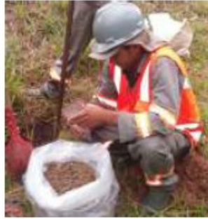
Figura 18 - Coleta de amostra deformada
