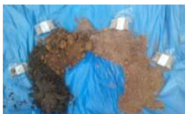
Figura 15 – Amostras de camadas de solos retiradas de um furo
