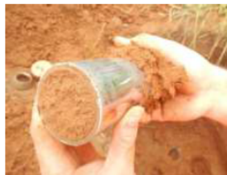
Figura 21- Retirada de uma amostra indeformada com cilindro Mini-CBR
