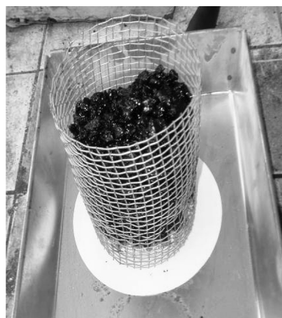
Figura 2 – Cesta usada no ensaio de escorrimento de misturas asfálticas não compactadas (AASHTO T 305/97).
