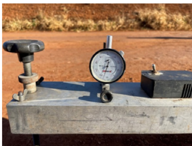
Figura 9: Execução do ensaio de viga Benkelman.
