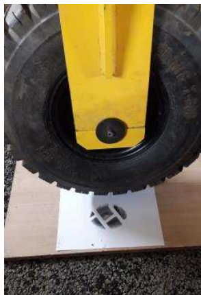
Figura 3: Registro da área de contato do pneu.
