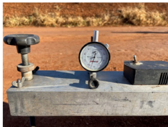
Figura 9: Execução do ensaio de viga Benkelman.
