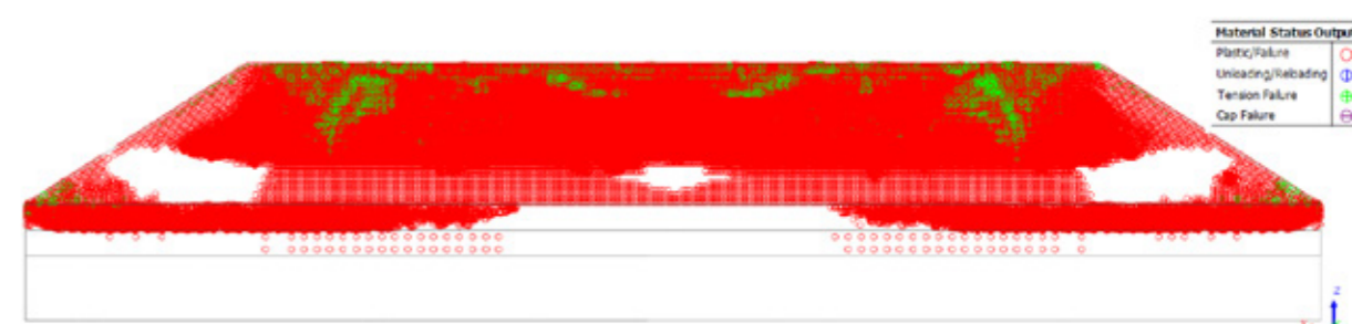
Figura 17: Zonas de plastificação modelo 3D de análise numérica do experimento na caixa em laboratório.
