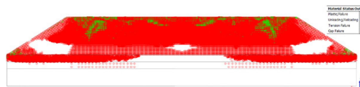
Figura 17: Zonas de plastificação modelo 3D de análise numérica do experimento na caixa em laboratório.
