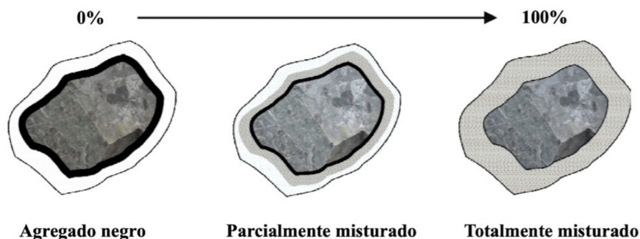
Figura 1: Ilustração de três cenários possíveis de misturas entre os ligantes asfálticos (novo e envelhecido). Fonte: Adaptado de GASPAR et al. (2020).
