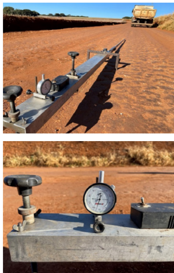
Figura 9: Execução do ensaio de viga Benkelman.
