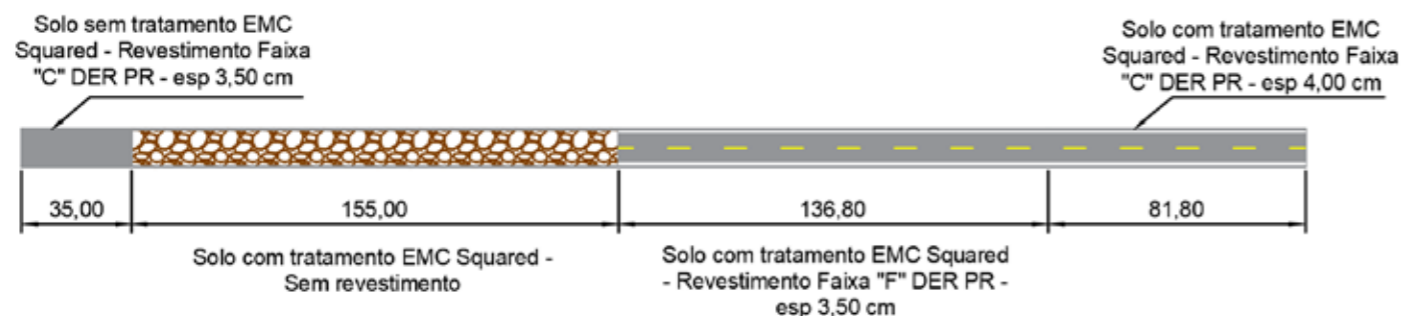
Figura 2: Esquema dos trechos experimentais executados nesta pesquisa.
