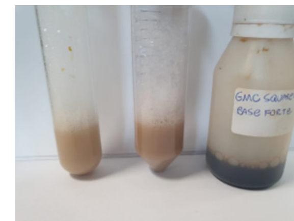
Figura 6: Teste expedito de agitação de um solo com gotas do produto.
