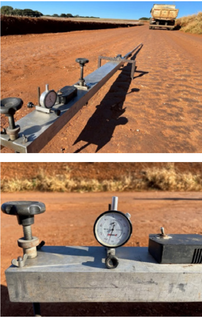
Figura 9: Execução do ensaio de viga Benkelman.
