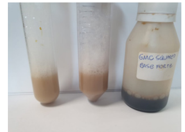
Figura 6: Teste expedito de agitação de um solo com gotas do produto.
