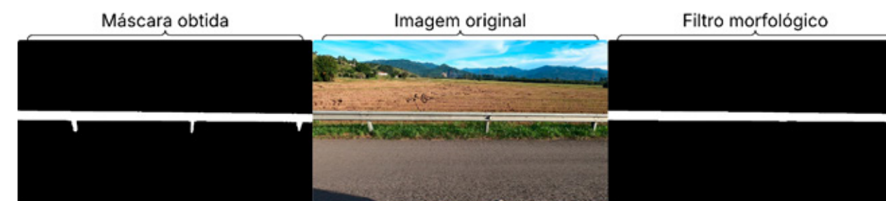
Figura 2. Resultado da aplicação do filtro morfológico para remoção dos suportes (Elaborada pelos autores, 2026)
